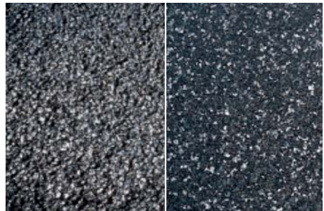
Agrega serpilmemiş ve serpilmiş TMA yüzeyleri (sol ve sağ taraftaki resimler)
