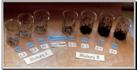
Stabilize edici katkı malzemelerin etkisi süzülme deneyi ile tespit edilir
