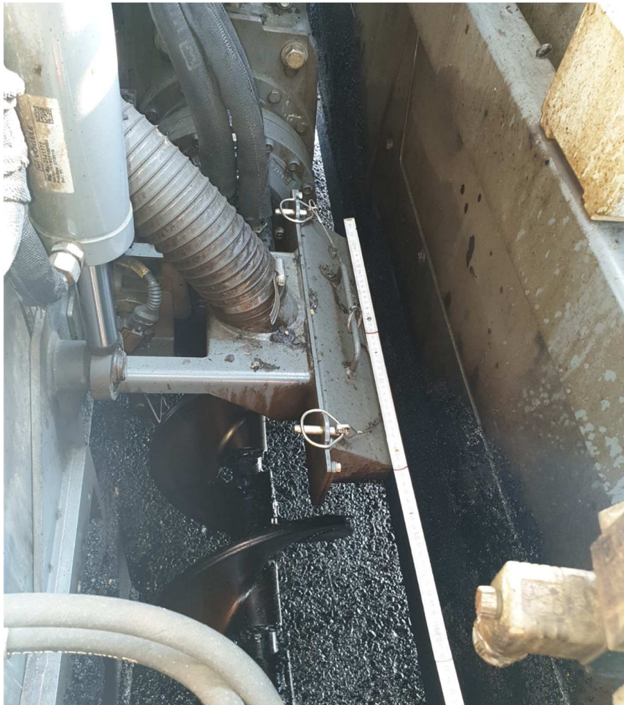
Abbildung 3: Absaugung an der Bohle eines Asphaltfertigers [16]
