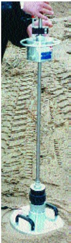
Um spätere Setzungen zu vermeiden wird als Eigenüberwachung und ggf. zum Nachweis der Verdichtung eine schichtenweise Verdichtungskontrolle empfohlen.
