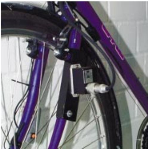
Beschleunigungsaufnehmer an der Vorderradgabel des Meßrades der Universität der Bundeswehr in München zur Zustandserfassung von Radwegbefestigungen
