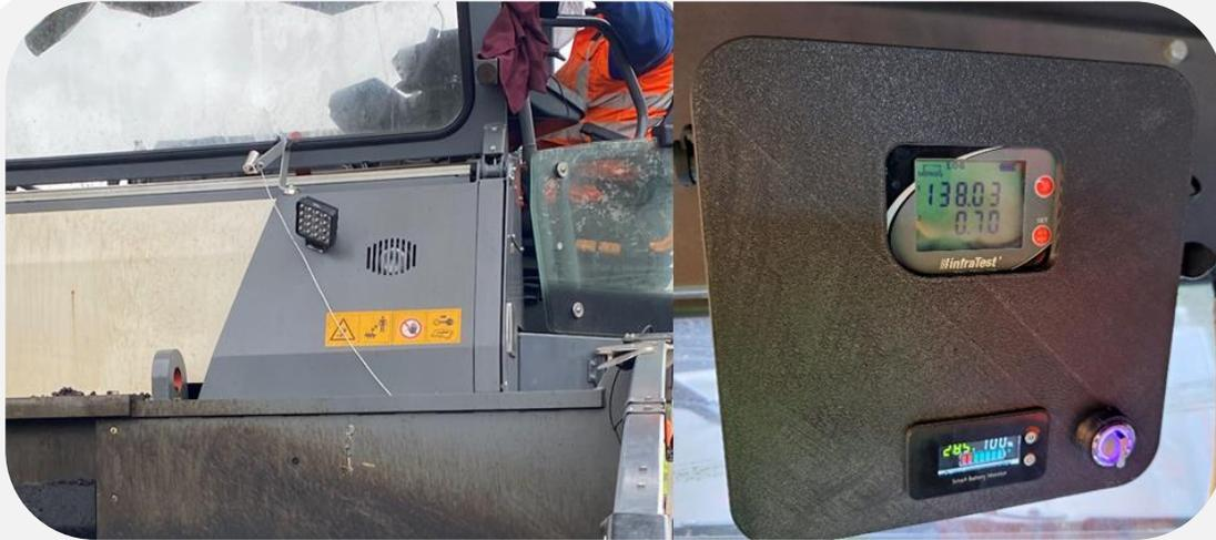
**Kontinuierliche Temperaturmessung von Asphaltmischgut bei der Übergabe in den Beschickerkübel**
