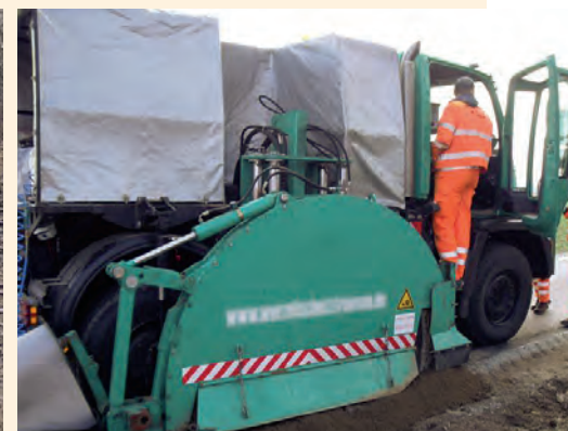
Wurzelschutzfräse zum Einbau einer Wurzelschutzfolie
