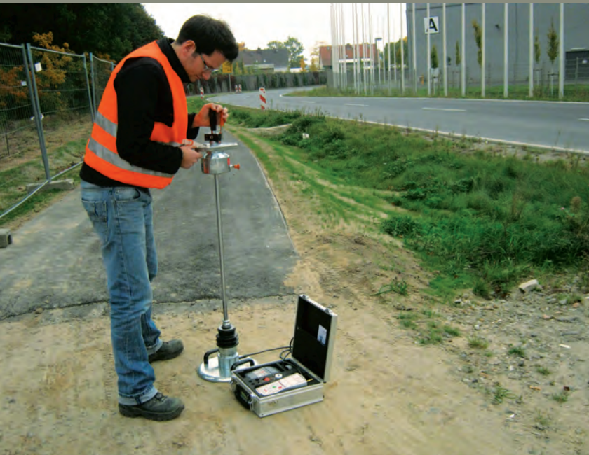
Ermittlung der Tragfähigkeit mit dem leichten Fallgewicht
