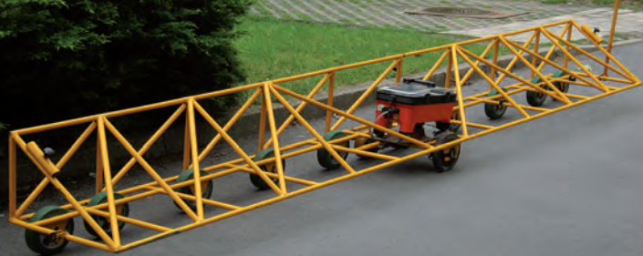
Längsebenheitsmessung mit Planograph
