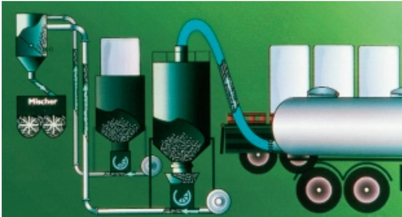
**Zugabe von stabilisierenden Zusätzen – automatisiert.**
