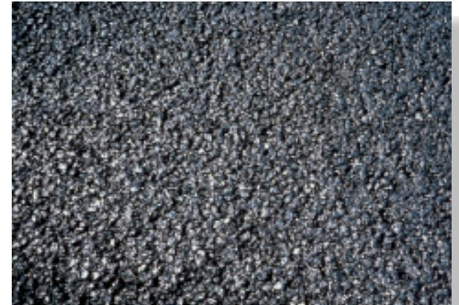
Nach dem Einbau, der Verdichtung und der Nachbehandlung ist bis zur Verkehrsfreigabe möglichst eine Zeitspanne von mindestens 24 Stunden zur Abkühlung der Deckschicht einzuhalten. Ein früheres Befahren der Deckschicht kann zu Verformungen in den Radspuren führen.
