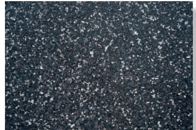
**Nicht abgestumpfte (oben) und abgestumpfte (unten) Oberflächen von Splittmastixasphalt-Deckschichten**
