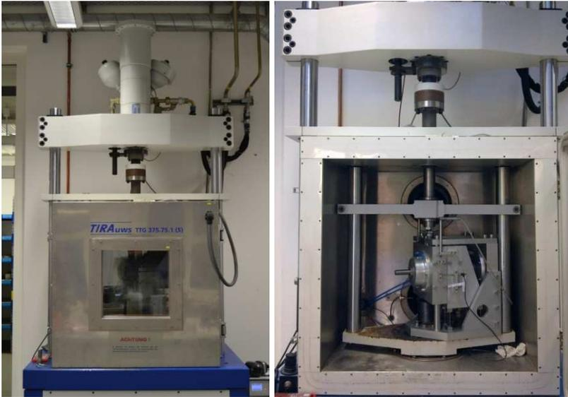
**Abbildung 3.5: Prüfmaschine SHM 63 mit Temperierkammer der TU Dresden**
