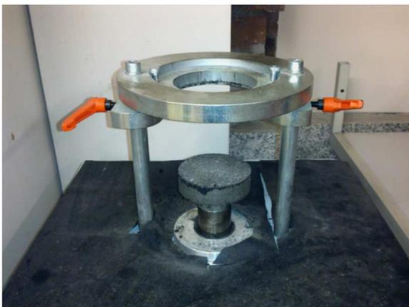
Abbildung 3.20: Auspressvorrichtung im Labor der TU Dresden
