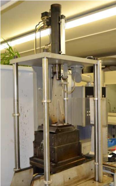
**Abbildung 3.1: Walzsektor-Verdichtungsgerät zu Herstellung von Asphaltplatten mit Abmessungen 320 x 260 mm an der TU Dresden**
