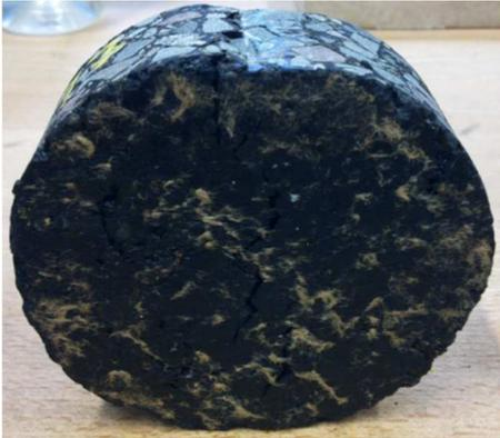
**Abbildung 3.17: Rissbildung im Asphaltprobekörper nach dem Ermüdungsversuch (Asphaltdeckschicht SMA 11 S)**
