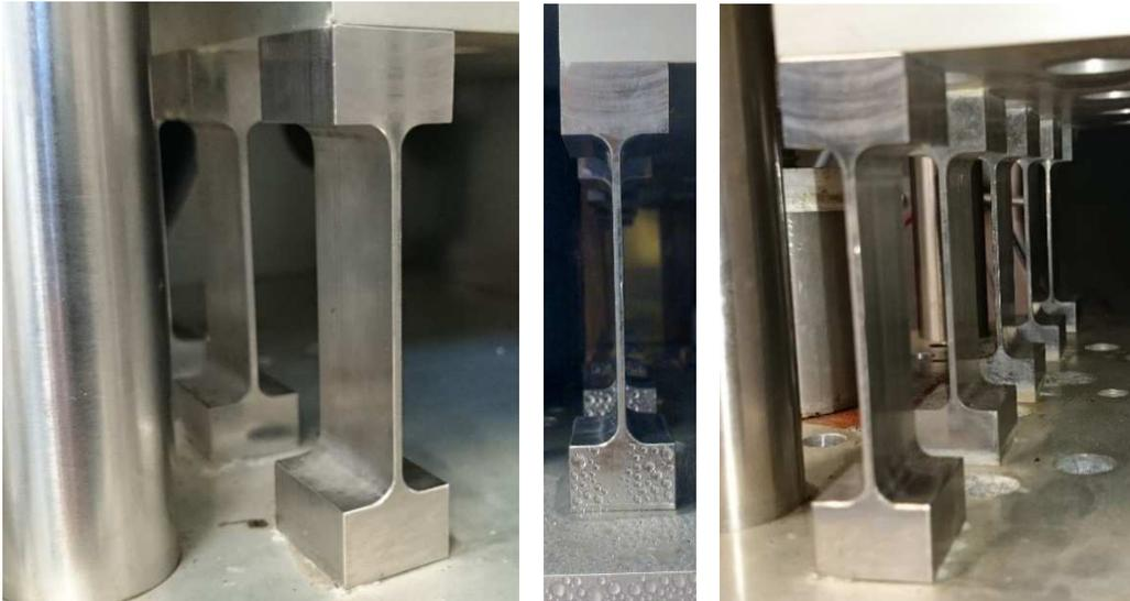
**Abbildung 5.5:** Präzisionslagern aus Edelstahl zur Vermeidung der vertikalen Bewegung des horizontal beweglichen Trägers
