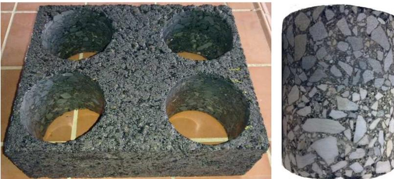
**Abbildung 3.2: Gebohrte Platte und Asphaltprobekörper**
