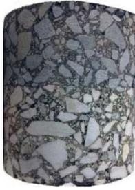
**Abbildung 1.1: Schichtengrenzfläche bei der Kombination Asphaltbinderschicht-Asphalttragschicht**
