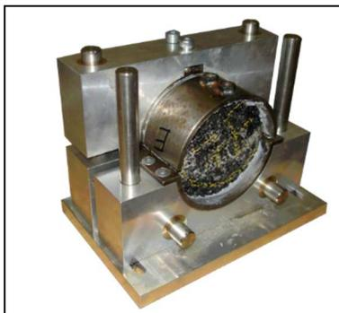
**Abbildung 2.24: Vorbereitungsvorrichtung zum Einkleben der Probekörper in den 4 Halbschalen nach Ascher (2007)**
