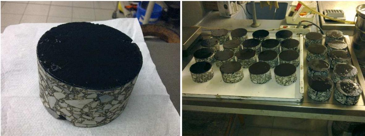
**Abbildung 5.24: Geschliffene Oberfläche der unteren Asphalterschicht mit aufgetragener Bitumenemulsion**
