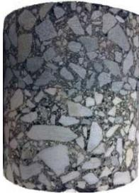
**Abbildung 1.1: Schichtengrenzfläche bei der Kombination Asphaltbinderschicht-Asphalttragschicht.**
