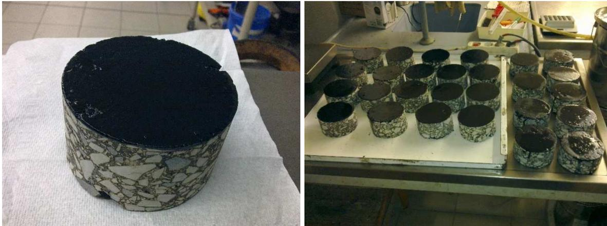
**Abbildung 2.3: Geschliffene Oberfläche der unteren Asphaltsschicht mit aufgetragener Bitumenemulsion.**
