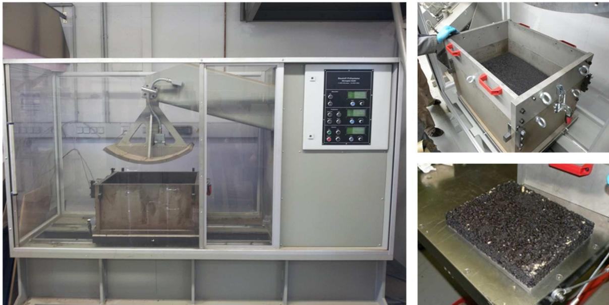
**Abbildung 22. Walzsektor-Verdichtungsgerät zur Herstellung großformatiger Asphalt-Probeplatten (500 x 700 mm<sup>2</sup>) (ISBS).**
