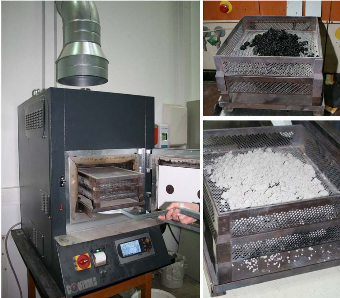
Abbildung 2. Verwendeter Thermo-Ofen (links), Asphaltmischgutprobe vor (rechts oben) und nach (rechts unten) der Thermoanalyse
