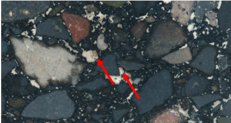
Abbildung 7: Anfärbung des Epoxidharzes mit weißer Farbpaste, die roten Pfeile markieren bräunliche Verfärbungen, die auf eine Bitumenanlösung hindeuten
