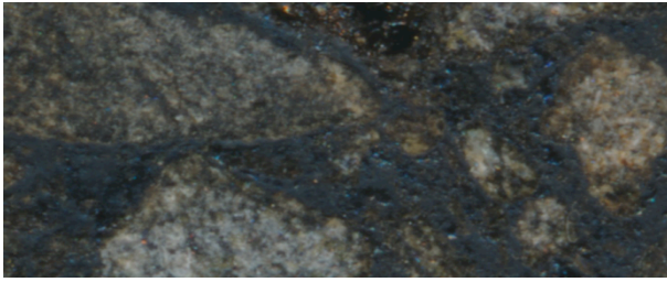
Nahaufnahme (7,4 x 3,7 mm) mit sichtbaren Verschmierungen und Kornaufrauungen
