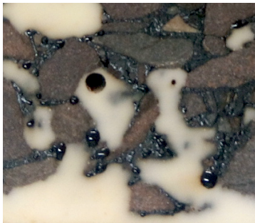
Abbildung 5: Ausbluten von Bitumen aufgrund zu hoher Hitzeentwicklung beim Aushärten
