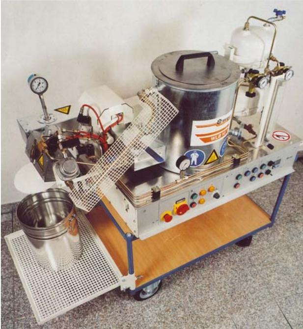
**Bild 1: Mobile Schaumbitumen-Laboranlage
