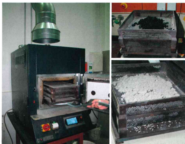
Abbildung 1: Verwendeter Thermo-Ofen (links), Asphaltmischgutprobe vor (rechts oben) und nach (rechts unten) der Thermoanalyse (Quelle: Uni Kassel/ Mollenhauer)
