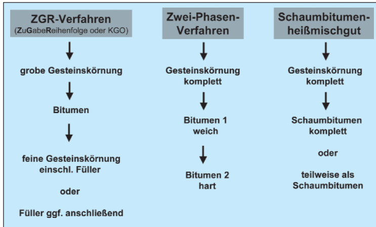
Abb. 1: Ablaufschema verfahrenstechnischer Maßnahmen
