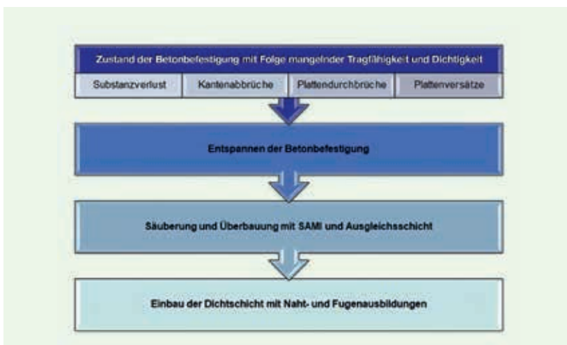
Abbildung 12: Einflüsse auf die Wahl der Sanierungsmethode (Quelle: Behle)
