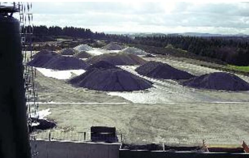
*Die getrennte Gewinnung und Lagerung des Asphaltgranulates ist Voraussetzung für eine hochwertige Verwendung*
