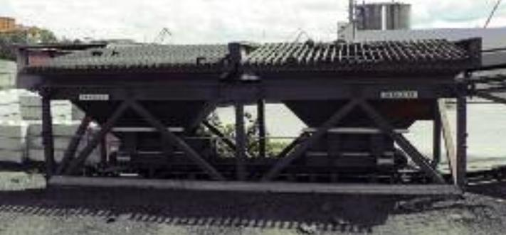
*Zwei getrennte Doseure für die Zugabe von Asphaltgranulat bei der Herstellung von Asphaltmischgut für Asphalttragschichten einerseits und Asphaltbinder- und Asphaltdeckschichten andererseits*
