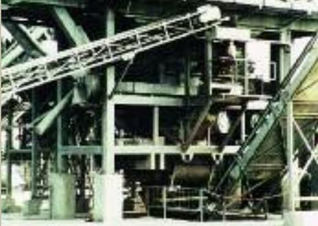
**Zugabe von (kaltem) Asphaltgranulat über eine Chargenwaage in den Mischer**
